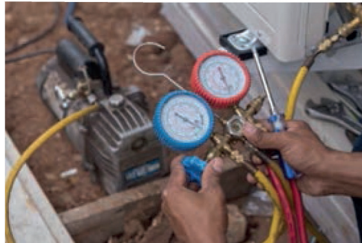
चित्र 4.5.3.10: मैनिफोल्ड गेट का उपयोग करके दबाव मापना
